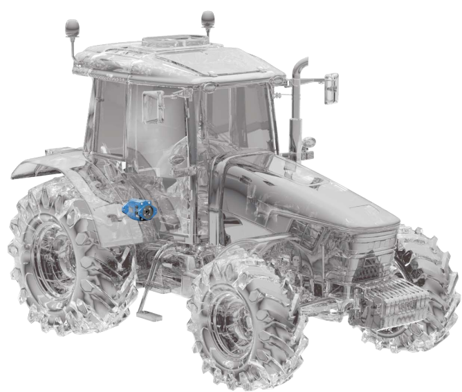
Пример использования A1VO в тракторе мощностью 90 л.с. / 66 кВт
