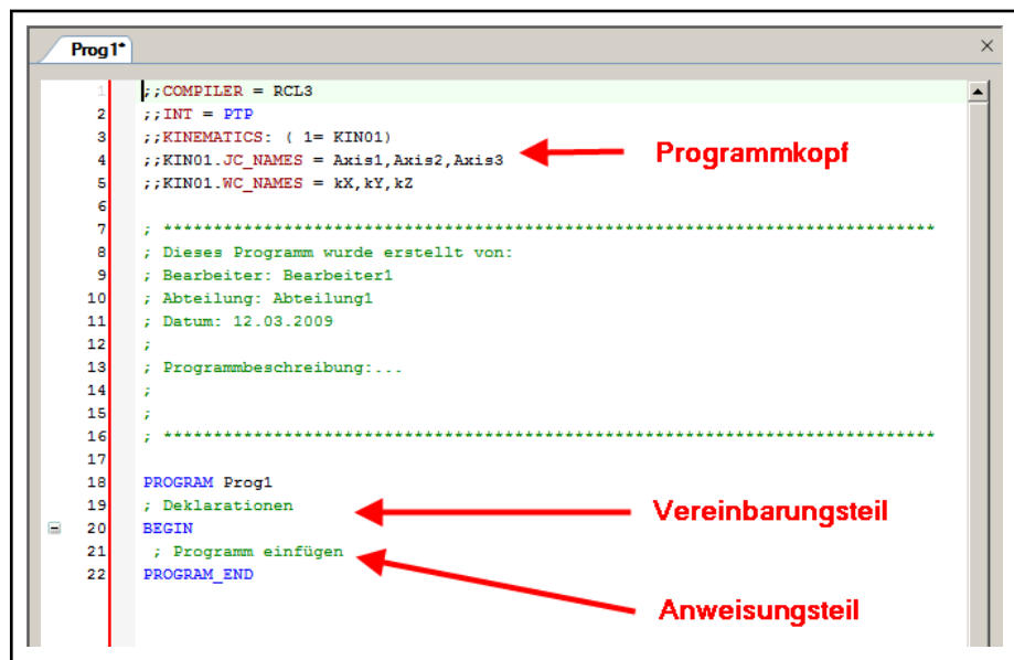
Abb. 10-21: Allgemeiner Aufbau eines RoCo-Programmes
