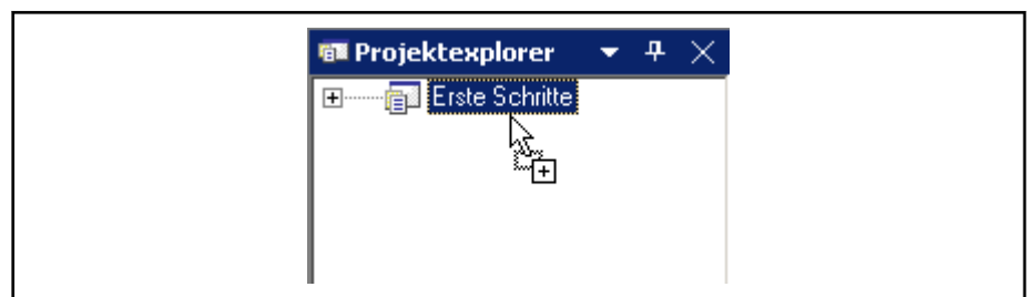
Abb.5-17: Anlegen einer Steuerung – Fallenlassen in Projektnavigator
