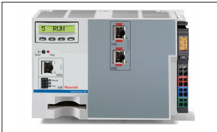
Abb.5-2: Beispiel: CML25.1 Hardware für IndraMotion MLC-Anwendungen
