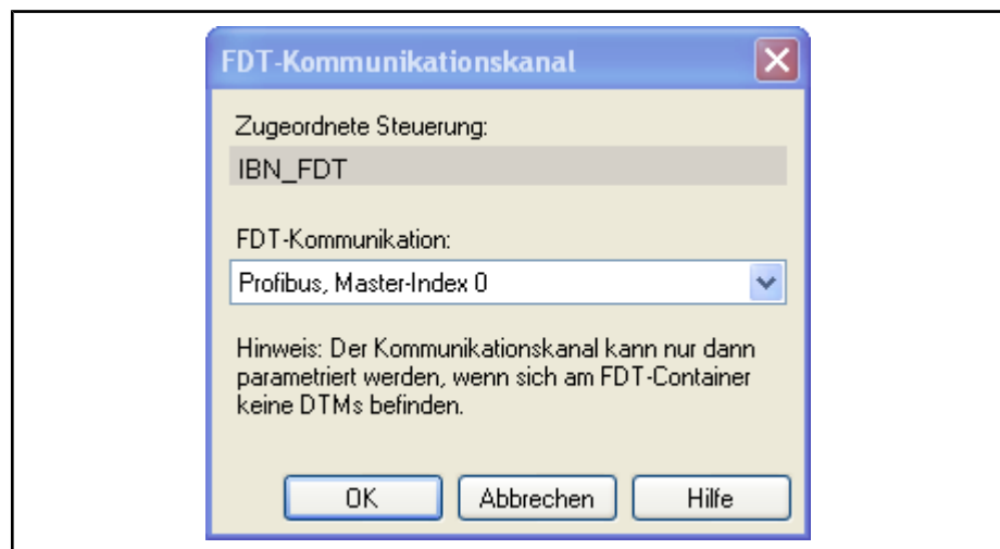
Abb.5-147: Einstellung des FDT-Kommunikationskanals
