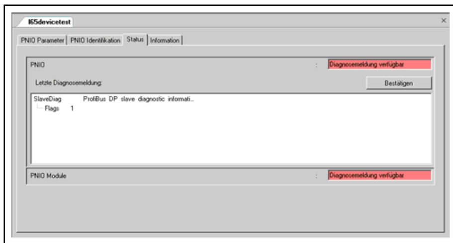
Abb.6-52: Statusdialog des PROFINET I/O-Device (Beispiel: Fehlende Netzwerkverbindung zum Device)
