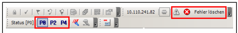
Abb.6-57: Statusanzeige des Controllers mit Fehler an einem Device
