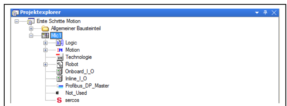
Abb.3-9: Projektextplorer: Projekt "Erste Schritte Motion" mit einer IndraMotion MLC L65-Steuerung mit sercos III Bus
