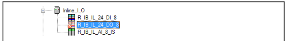
Abb. 3-36: Inaktiver Zustand eines Inline-Moduls
