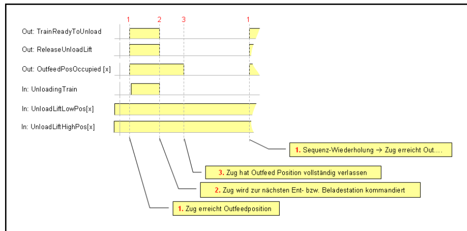
Abb. 4-34: Signal Zeit Diagramm beim Entladen ohne Unload-Handshake
