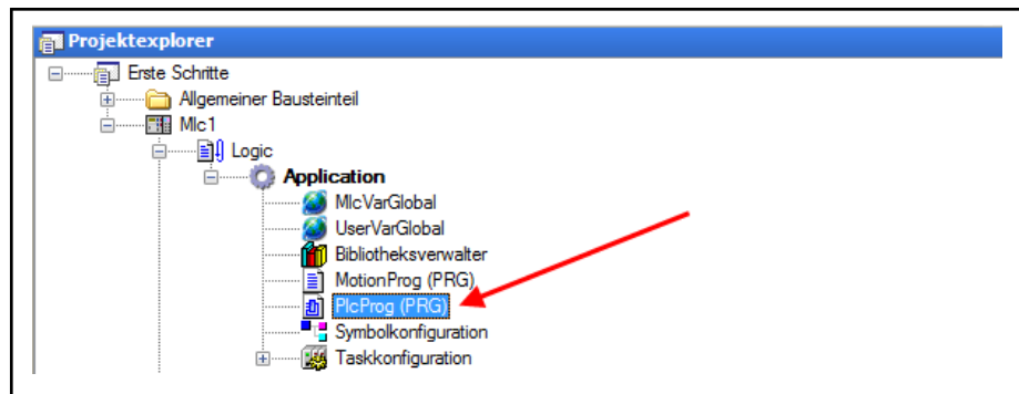
Abb.2-12: POU "PlcProg" in die Applikation eingefügt
