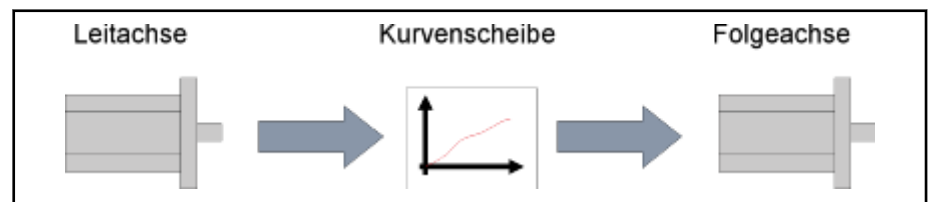
Abb. 7-43: Signalfluss und die Kurvenscheibe-Lokalisierung
