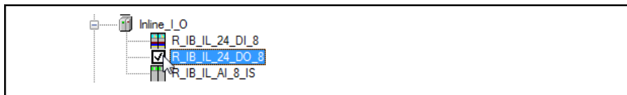
Abb. 3-34: An-/Abwählen eines Inline-Moduls
