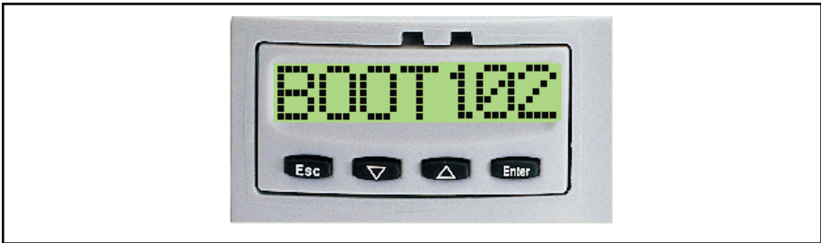
Abb. 3-5: Reboot der Steuerung
