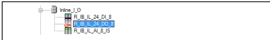
Abb. 3-36: Inaktiver Zustand eines Inline-Moduls
