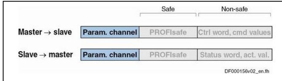
Fig. 7-27: Parameter channel configuration
