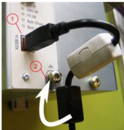
Abb. 10-6: USB-Kabel an Funktionserde der USV befestigen
