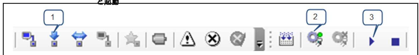
図 11-20: PLC のダウンロード (設定/PLC オブジェクト) と起動
