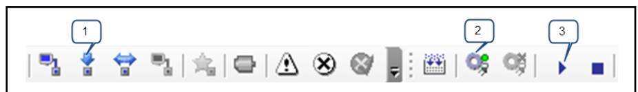
図 10-23: PLC のダウンロード (設定/PLC オブジェクト) と起動
