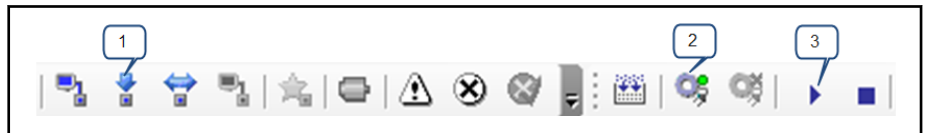
図 8-11: PLC のダウンロード (設定/PLC オブジェクト) と起動
