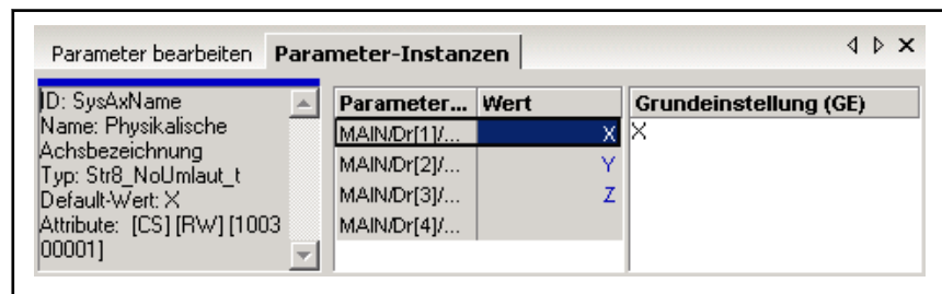
Abb. 3-10: Beispiel: in den Kern-Anzeigebereich gelegter Anzeigebereich "Parameter-Instanzen"
