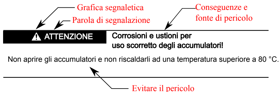
Fig. 3-1: Struttura delle norme di sicurezza
