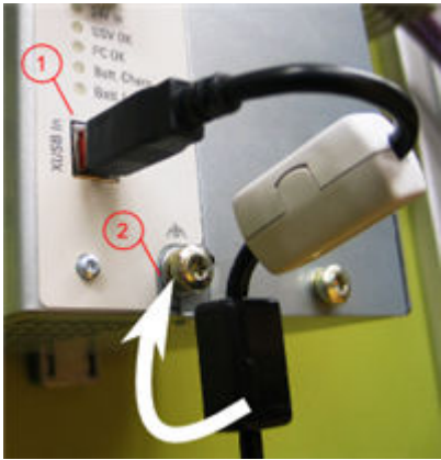
插图 10-6: 将 USB 电缆连接到 UPS 的功能接地连接
