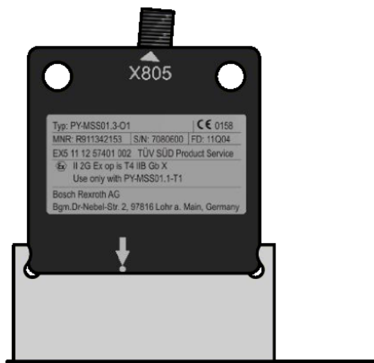
Fig. 10-7: Cappuccio protettivo come supporto al montaggio
