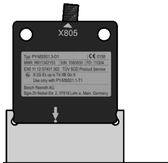
Fig. 10-7: Capuchon de protection en tant qu'aide au montage
