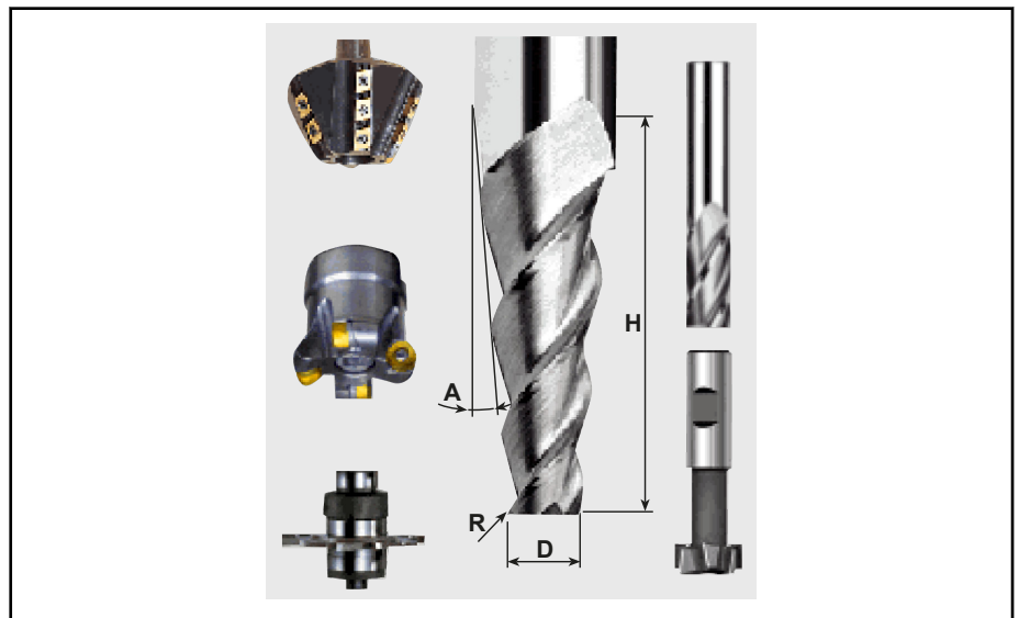
Abb. 9-15: Werkzeugbeschreibung TOOL/MILL zylindrischer oder Kegelfräser mit optionalem Eckenradius
