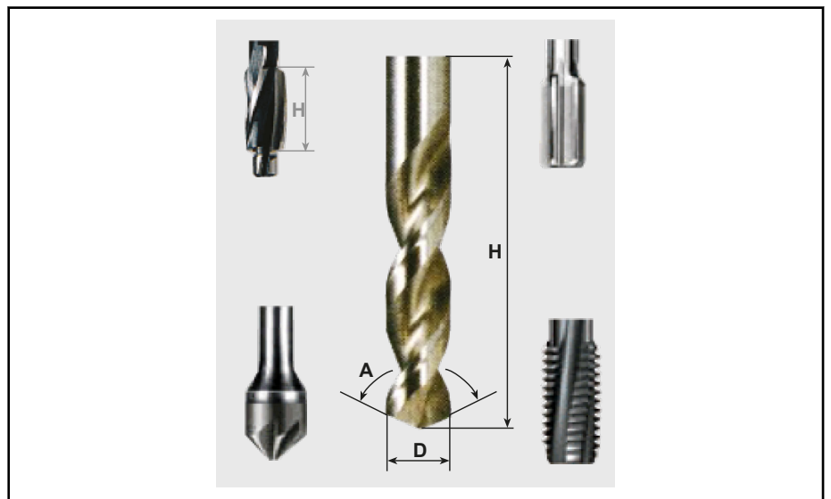
Abb. 9-12: Werkzeugbeschreibung TOOL/DRILL Bohrer, Senker, Reibahle
