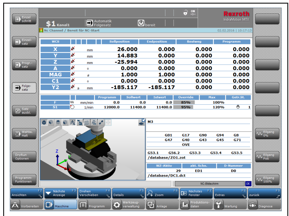
Abb. 4-1: NC-Simulation im NC-Bildschirm (Betriebsart Automatik)
