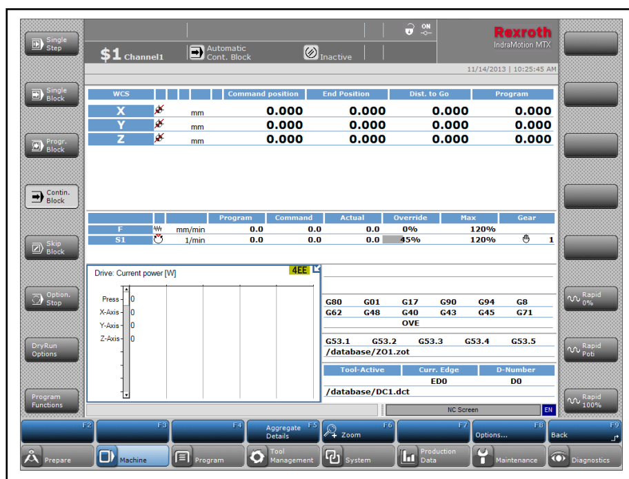
Fig. 10-11: Puissance des entraînements
