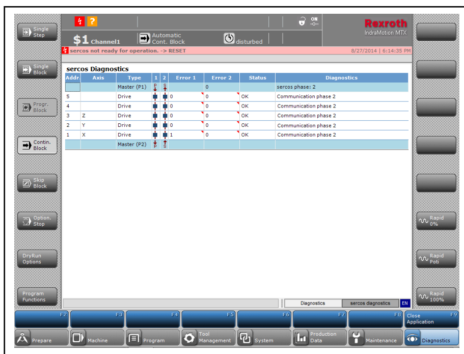
Fig. 9-40: Intégration du diagnostic Sercos sur le bureau utilisateur
