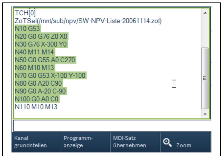
Abb. 4-23: Abarbeiten eines Blocks von NC-Sätzen (Schritt 1)
