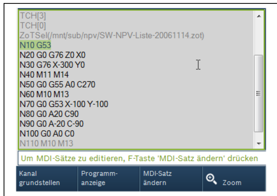
Abb. 4-24: Abarbeiten eines Blocks von NC-Sätzen (Schritt 2)
